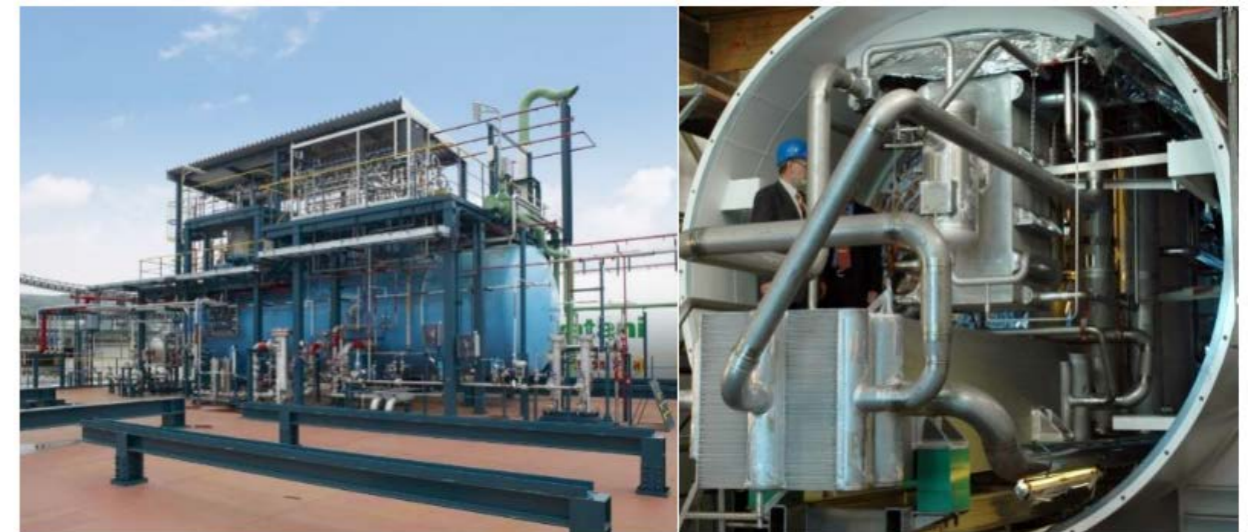
图3 Linde 公司氢液化装置及典型液化冷箱内部结构（图源：Linde Group）
